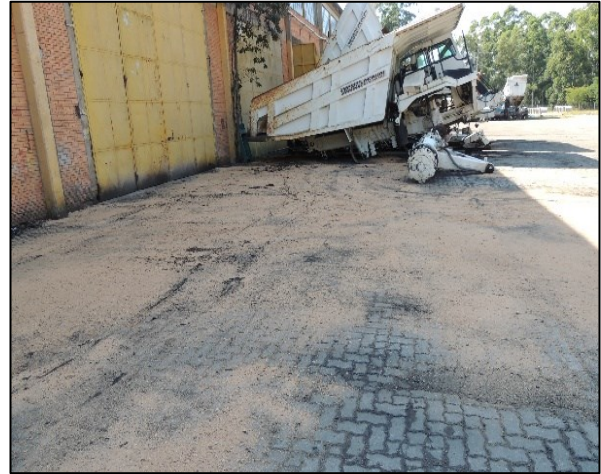
Figura XX – A fim de absorver o vazamento, foi colocada serragem em toda a imediação do local (FEV/2019).
